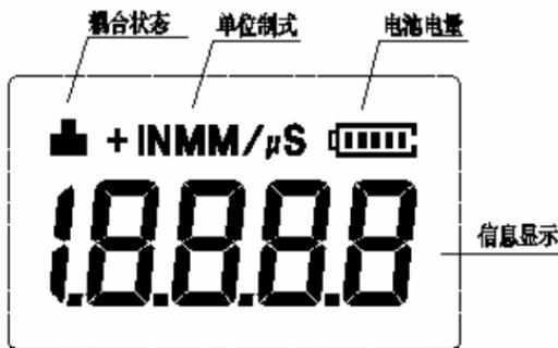
**耦合状态：**探头与被测工件的耦合状态
