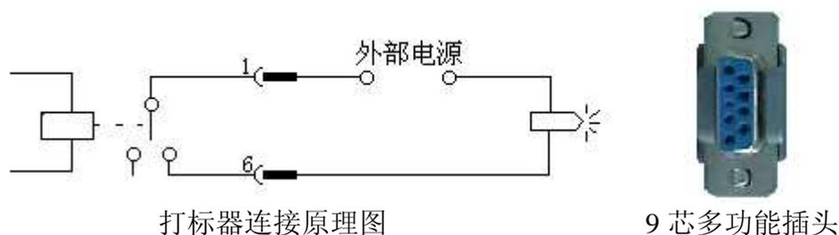
图 6. 打标器的连接
